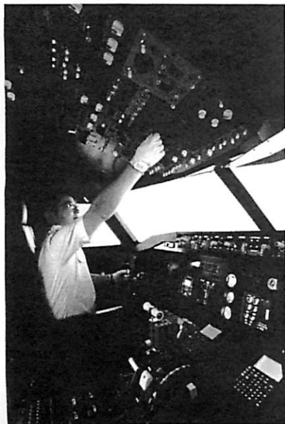
ボーイング737-800を模擬したBS21。昨年崇城大学に納入した。ほかにも3つの大学で日本ビーテーエーが製造した737-800フライトシミュレーターを使用している
