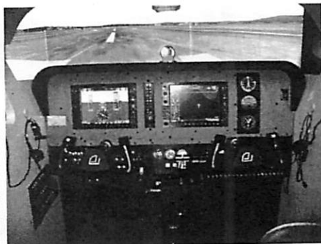
アビオニクスは複合グラスコックピットのガーミン G1000 を搭載
